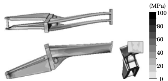
図4 非対称荷重条件における解析結果（応力分布）
