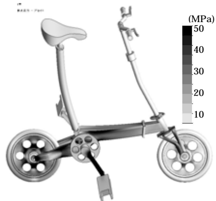
図5 フレーム強度解析結果（応力分布）
