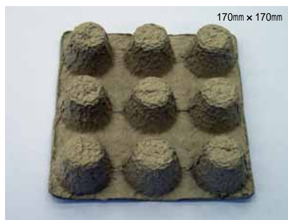
図1 実験用試料(丸型・40mm・15°)
