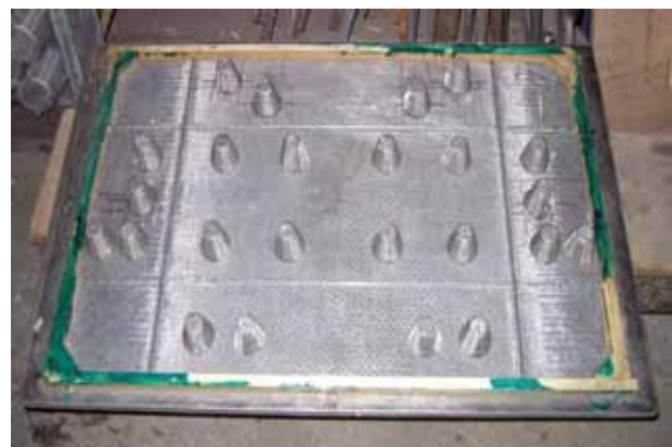
図8 汎用化構造モデルの金型
