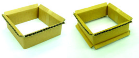
片側折曲げモデル 両側折曲げモデル 写真2 段ボール構造体実験モデル(2)
