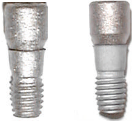
未処理品 H A Pコーティング品 写真5 H A Pショットコーティング例
