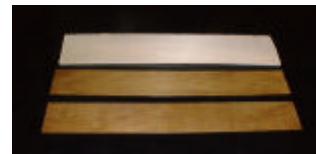
供試材寸法 50mm(幅)×2mm(厚さ)×280mm(長さ) 加熱温度 :200 加熱時間 0.6MPa以上で10min
