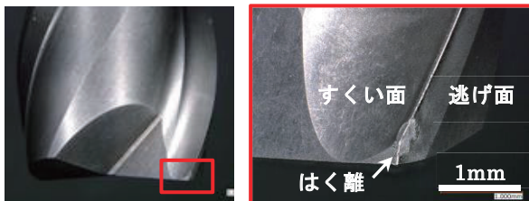
図 2 コーティングがはく離した工具の写真
