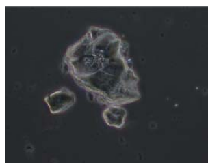
図 1 試作シリカゲルの位相差顕微鏡像 (×200)
