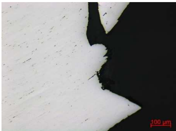
金属顕微鏡による破面起点部の断面像
