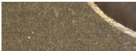
ショットブラスト処理前の金属製品表面写真
