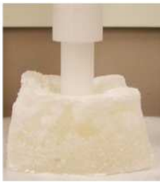
(上) 円柱型プランジャーを用いた求肥のテクスチャー解析 (右)くさび型プランジャーを用いたういろの破断強度解析
