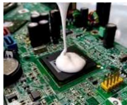
注入材による基板の封止
