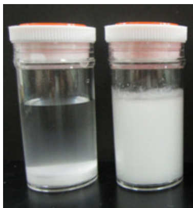
アルコール中のセルロース (左:未加工試料、右:ナノファイバー加工試料)
