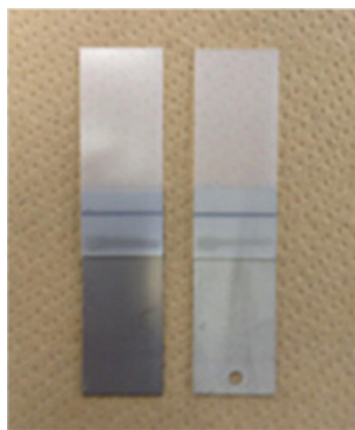
樹脂(上)と金属(下)を接合した自動車の試験片
