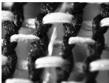
図14 仮糸の織り込み方法（機上）
