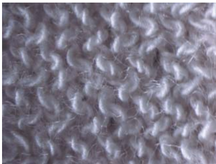
図 5 1S1Z の仕上げ後の外観
