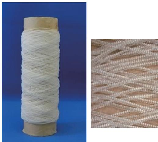
図3 撚糸機を用いて加工したコイル状繊維
