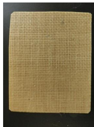
図8 繊維含有率を70wt%程度まで高めたNFRP
