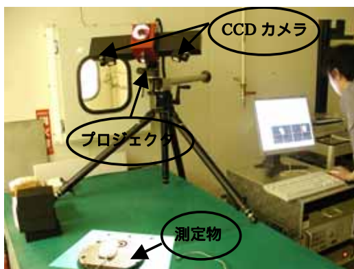
図1 当所のデジタイザ(GOM社 ATOS)による測定 -競輪補助設備-
