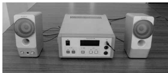
手のリハビリ装置の外観 (指動音楽演奏装置)
