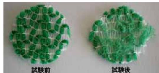
写真1 マーチンデル試験による外観変化
