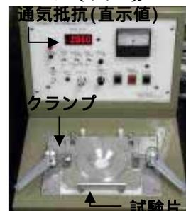
図3 KES通気性試験機
