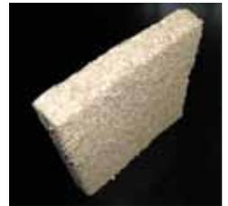
開発した断熱・吸音材
