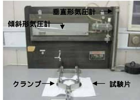
図2 フラジール形通気性試験機
