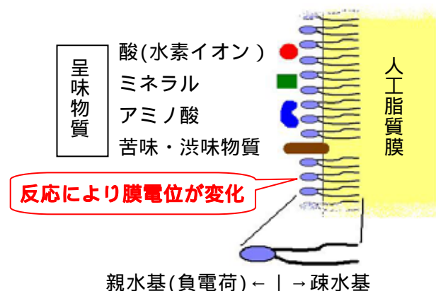
図 味覚センサーの構造と応答原理
