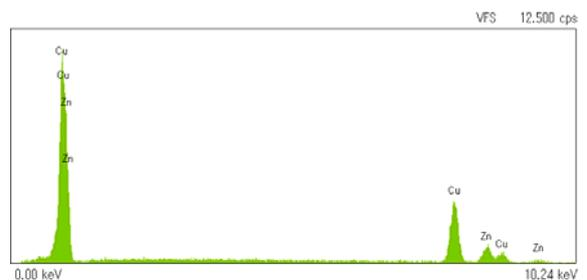
図2 銅上の亜鉛めっき皮膜の分析スペクトル
