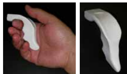
図3 切削型RP装置で造形したモデル
