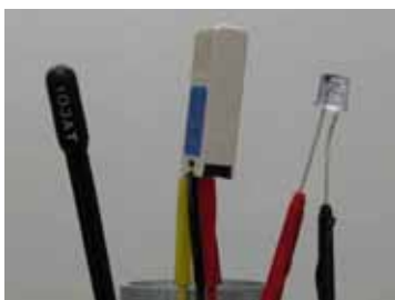
図1 サーミスタ(左) 湿度センサ(中央) 照度センサ(右)
