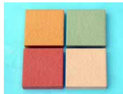
試作したヒートアイランド対策用保水建材
