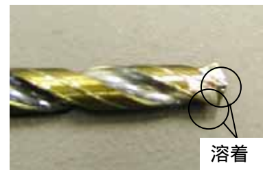
図3 ドリル先端部にアルミニウム合金が溶着した状態
