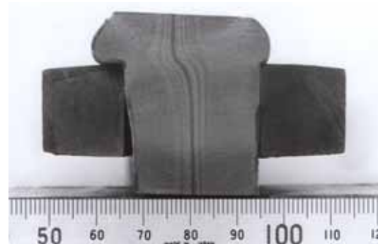
図2 DBヘッドの縦方向断面
