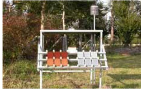
写真 暴露試験の実施状況
