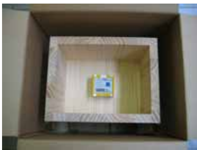
写真 木箱を用いた輸送試験用包装品
