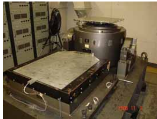
図 電磁式振動試験装置の外観
