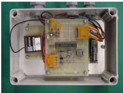
図 1 無線通信システム送信部
