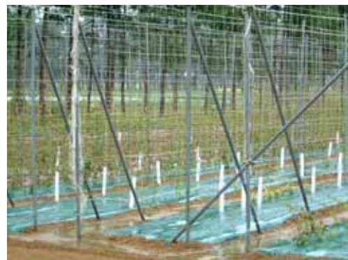
図1 生分解性繊維のフィールドテスト（長芋ネット）
