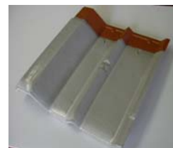
無鉛無ホウ素釉薬 を用いた粘土瓦
