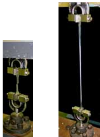
図2 ポリ乳酸(左写真)及び乳酸エステル含有ポリ乳酸(右写真)の引張試験
