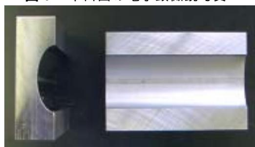
図2 成形金型の例
