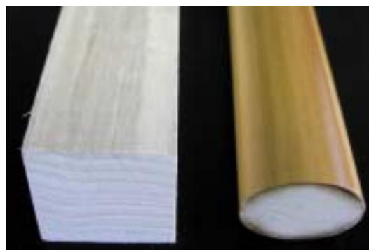
図3 圧縮成形加工による手すりの試作例
