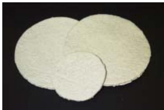
写真 試作した廃紙ボード
