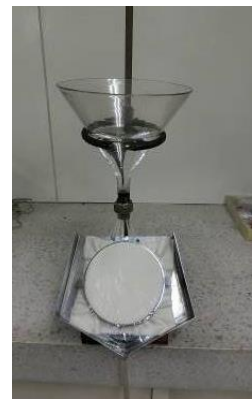
図3 撥水度試験装置
