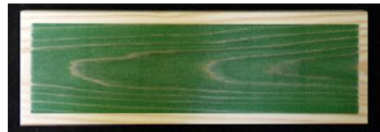
図3 表面へ樹脂（塗料）を含浸処理した試料
