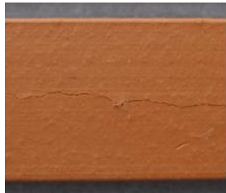
図2 焼成温度1030℃試験片(凍害試験11回)
