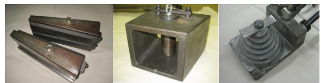
図2 引張試験に用いるつかみ治具 (くさび式治具、ピン式治具、渦巻式治具)
