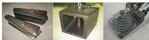
図2 引張試験に用いるつかみ治具 (くさび式治具、ピン式治具、渦巻式治具)
