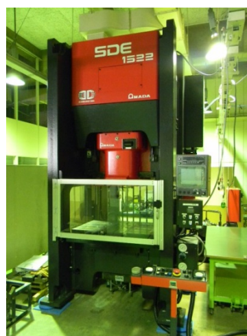
図3 サーボプレス〈SDE-1522〉 (加圧力1500kN, ストローク225mm)
