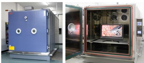
図1 左:減圧恒温恒湿槽(同型機)、右:試験槽内部
