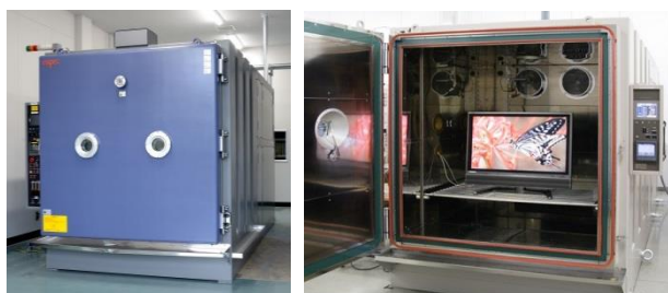
図1 左:減圧恒温恒湿槽(同型機)、右:試験槽内部
