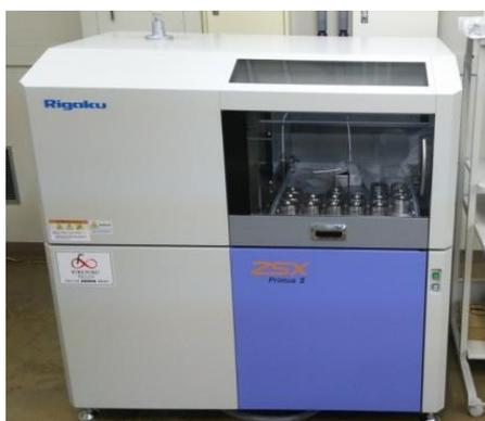
図1 波長分散型蛍光 X 線分析装置
