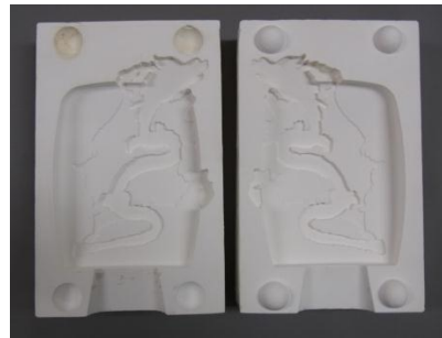
図4 三次元加工機により作製した石膏型
