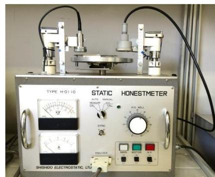
**図3** 帯電電荷減衰度測定器
