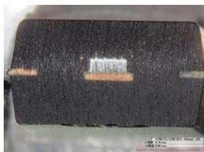
図2 ICチップ切断面
