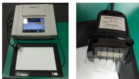
図 1 低抵抗率計（左）とプローブ電極（右）
