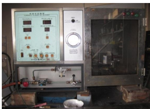
図1 45°燃焼性試験器（スガ試験機㈱製）
