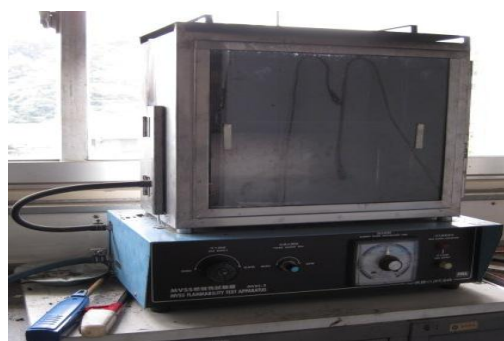
図2 水平法燃焼性試験器（スガ試験機㈱製）
