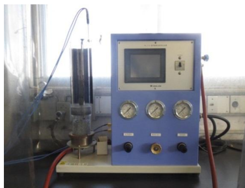
図3 限界酸素指数測定装置 （㈱安田精機製作所製）
