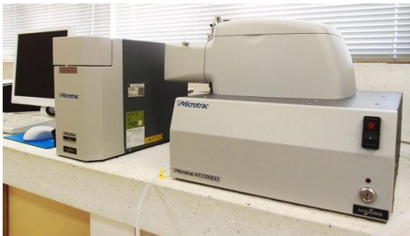
図1 レーザー回折・散乱式粒度測定装置（日機装(株)マイクロトラックMT3300EX-II、水・有機溶媒両対応、測定可能粒径0.02~2000 μm、溶媒量200 ml）
