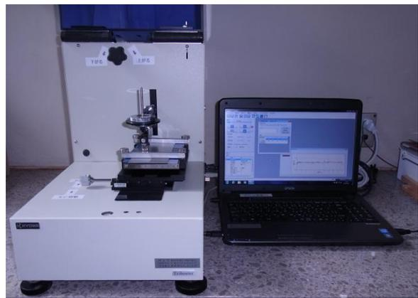
図3 自動摩擦摩耗解析装置
