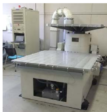
図 1 大型振動試験装置
