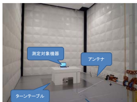
図 3m 法電波暗室
