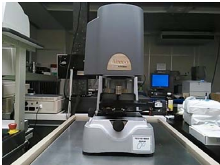
図1 干渉式非接触粗さ計 (公財) JKAの補助事業により平成22年度に導入
